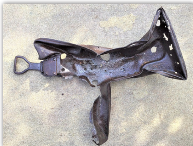
Deksel van MG-munitiekistje door de klap binnenstebuiten gekeerd en geperforeerd. Collectie SLS 39-45.
