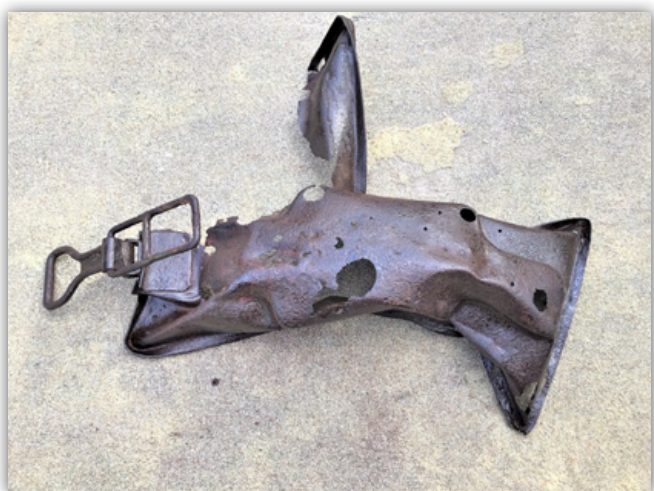
Deksel van MG-munitiekistje door de klap binnenstebuiten gekeerd en geperforeerd. Collectie SLS 39-45.
